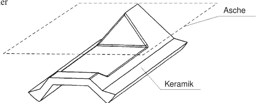
**Maximale Aschenmenge nur bis zur Oberkante des Dachs !**
