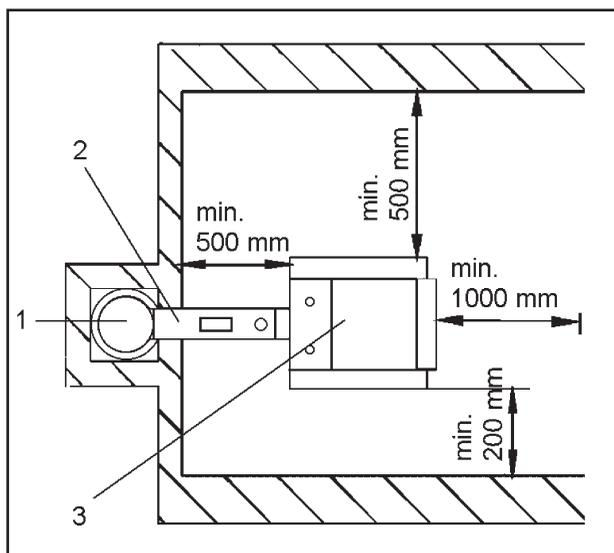
Die Kessel können in „grundlegender Umgebung“, AA5/AB5 laut ČSN3320001/1995 verwendet werden. Die Kessel müssen in einem Kesselhaus aufgestellt werden, in dem ein ausreichender, für die Verbrennung erforderlicher Luftzutritt sichergestellt wird. Es ist unzulässig, Kessel im Wohnraum (einschl. Gänge) zu installieren. Der Querschnitt der Öffnung für die Verbrennungsluftzufuhr in das Kesselhaus muss für Kessel mit Leistungen von 20 – 75 kW mindestens 250 cm<sup>2</sup> betragen.
