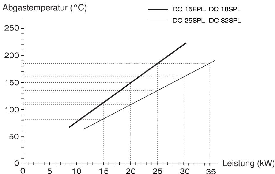
Es handelt sich um die lineare Abhängigkeit bei stabilisiertem Zustand bei gereinigtem Kessel
