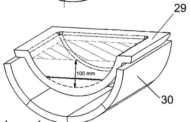
**Maximale Aschenmenge – bis zur Hälfte des Kugelraums !**
